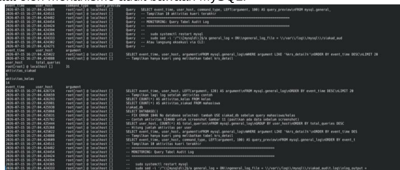
Gambar 10. Screenshot audit logging MySQL: Aktivitas kueri pada basis data SIAKAD yang tercatat otomatis di tabel mysql.general_log.
