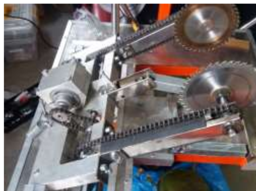
Gambar 16. Pengujian Menggunakan Sistem Sprocket.
