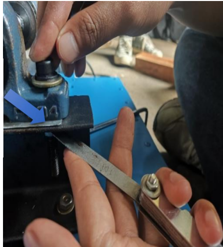
Gambar 3. Pengukuran celah kelonggaran baut
