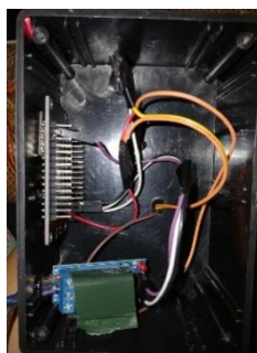
Gambar 6. ESP8266 dan relay
