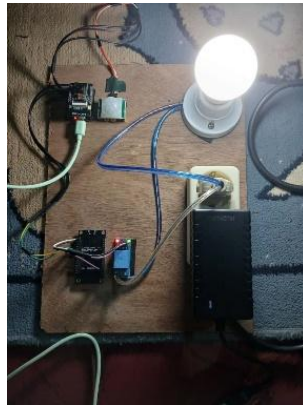
Gambar 9. Lampu menyala karena instruksi telegram bot
