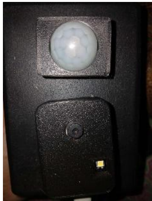
Gambar 7. ESP32-CAM dan sensor PIR
