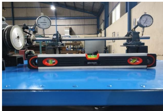
Gambar 3 Proses alignment poros menggunakan dial indicator.
