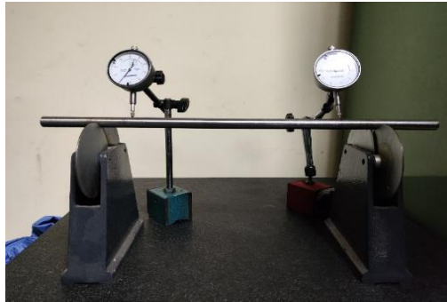
Gambar 2 Proses pengukuran kesilindrisan poros pada stand block.
