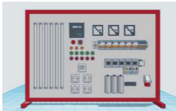
Gambar 2. Desain Trainer Perbaikan Faktor Daya
