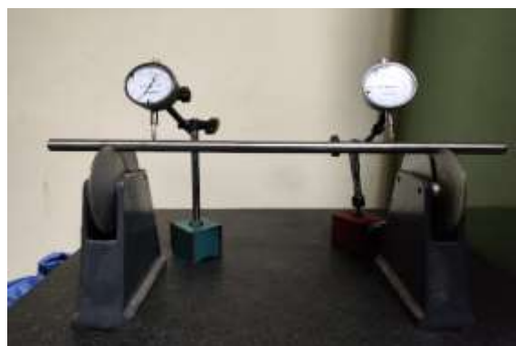
Gambar 3. Proses pengukuran kesilindrisan poros pada stand block.
