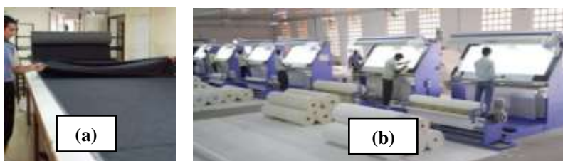
Gambar 1. Perbandingan inspeksi kain secara: (a) manual, dan (b) otomatis [6]
