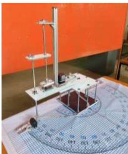
Gambar 4. Hasil Perakitan Robot SCARA
