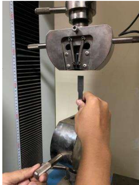
Gambar 3. Proses pemasangan sample Uji
