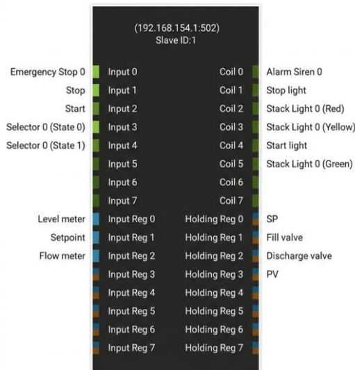
Gambar 3.2. Konfigurasi Modbus Slave pada Virtual Plant di Factory IO
